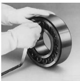
Obr. 1. Kontrola radiální vnitřní vůle ložiska na pracovním stole.
